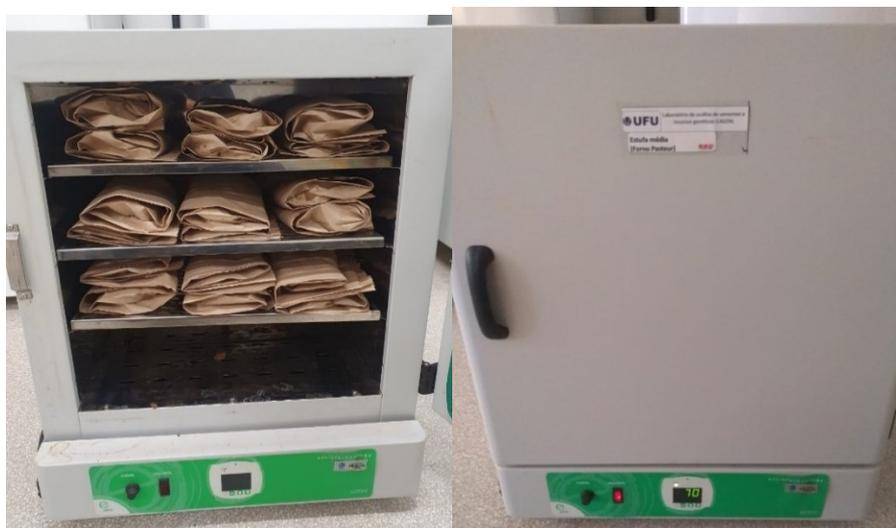
**Figura 6:** Estufa para a secagem das folhas e raízes da alface para determinar massa seca (Fonte: AUTOR, 2021).
