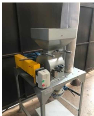
Figura 3.4: Moinho de martelo utilizado para cominuição. Fonte: Autora, 2019.
