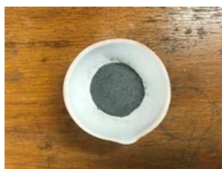
Figura 4.1: Pó resultante da cominuição e peneiramento das placas de circuito impresso em cadinho de porcelana (Amostra I). Fonte: Autora, 2019.
