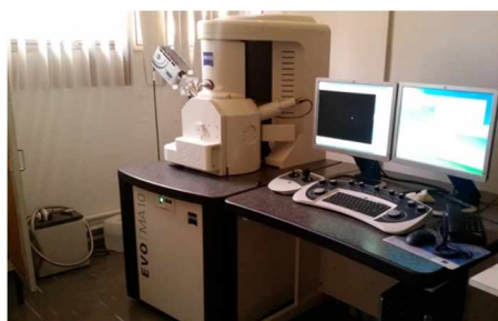
Figura 3.13: Equipamento de microscopia eletrônica de varredura, situado na Faculdade de Engenharia Química da Universidade Federal de Uberlândia. Fonte: Autora, 2019.
