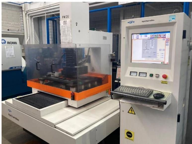
Figura 3. 3 - Máquina de corte por eletroerosão a fio utilizada para fabricação dos corpos de prova do tipo C(T) TL-S.
