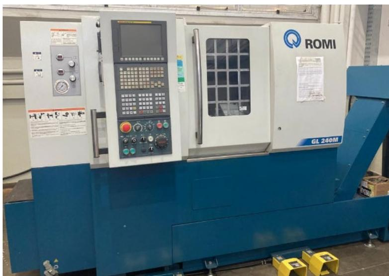
Figura 3. 5 - Torno CNC Romi GL 240M utilizado na fabricação dos corpos de prova do ensaio de tração.
