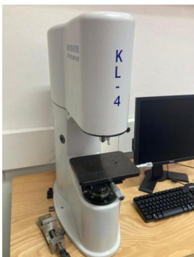
Figura 3. 7 - Medidor de Dureza Rockwell C Reicherter Stiefelmayer KL-4, utilizado na medição de dureza dos corpos de prova do tipo C(T).
