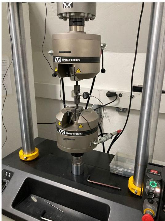
Figura 3. 8 - Corpo de prova C(t) montado no equipamento para abertura de trinca por fadiga
