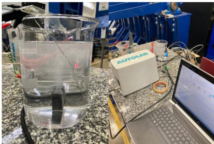
Figura 3. 9 - Aparato utilizado para condução do procedimento de permeação de hidrogênio nos corpos de prova.
