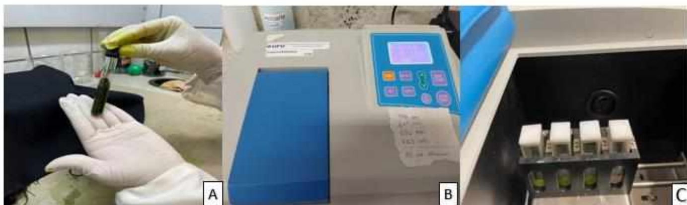
Figure 5. Imagens ilustrativas das amostras adicionadas a solução de éter de petróleo e acetona (A); espectrofotômetro UV-190 utilizado (B); amostras triplicatas por planta (C).
