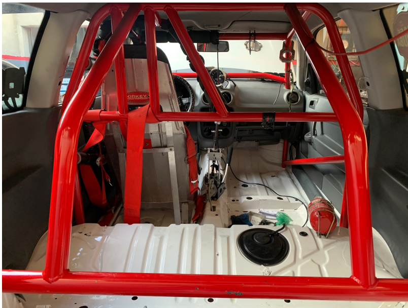
Figura 28 – Gaiola de proteção
