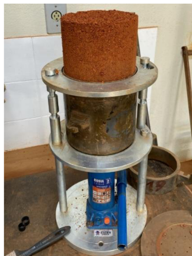
Figura 6 – Aspecto do RCC compactado durante a extração da amostra.
