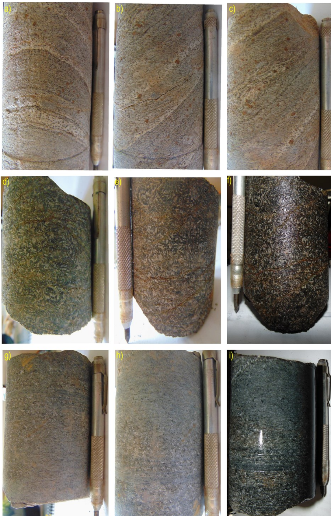
Figura 10. Amostra de mão de testemunhos de sondagem. a - c) Micaxisto do Grupo Araxá. d - f) Corpo anfibolítico fácies grossa. g - i) Corpo anfibolítico, fácies fina. f) e i) amostras molhadas.
