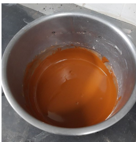
Figura 7 – Compósito após homogeneização em misturador mecânico
