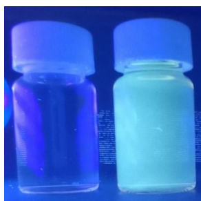
Figura 57: Sobrenadante da produção da MCC-S (direita) e água ultrapura (esquerda) sob luz ultravioleta
