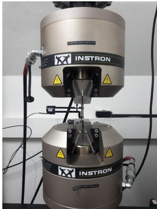
Figura 13: Equipamento para realização do ensaio de tração.
