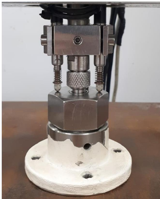
Figura 18: Equipamento de puncionamento.
