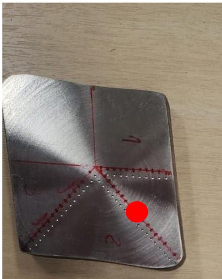
Figura 14: Posição a meio raio de onde foram retiradas as amostras.
