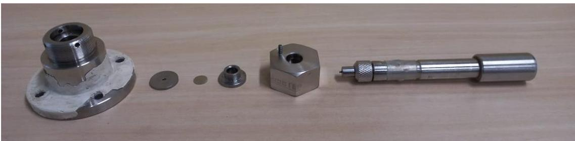
Figura 17: Componentes do dispositivo de puncionamento.
