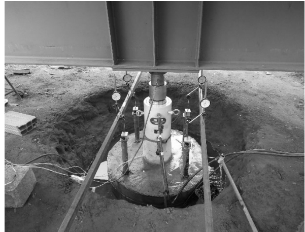
Figura 69. Prova de carga em sapata estaqueada condição inundada SPES-EXP-INUND.
