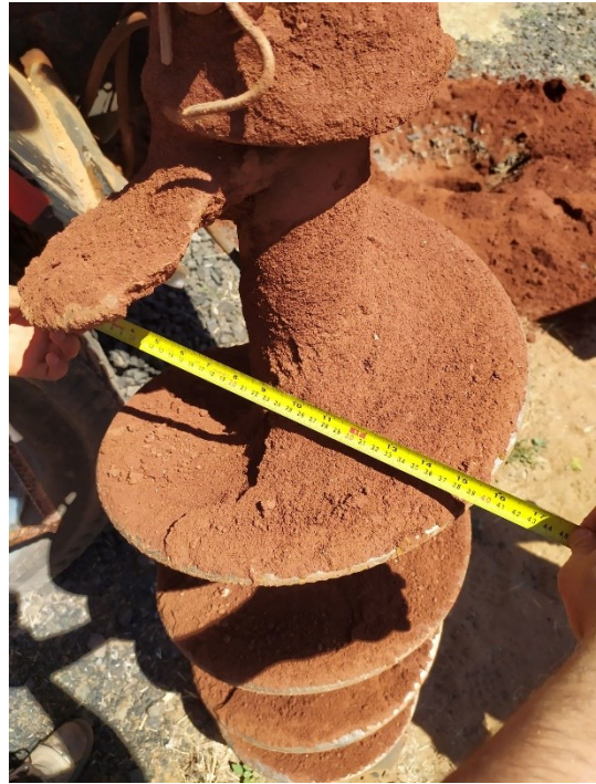
Figura 51. Trado helicoidal d = 40 cm.
