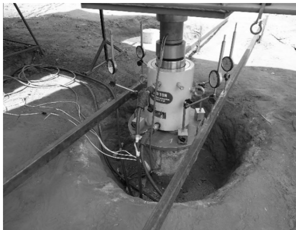
Figura 66. Prova de carga em estaca isolada em condição natural ES-EXP-NAT.
