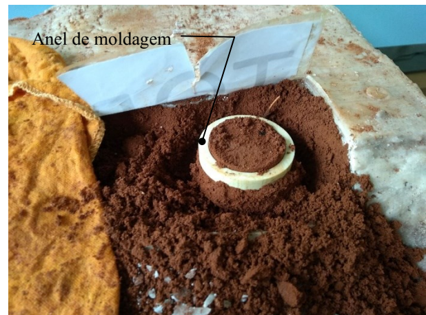
Figura 41. Moldagem dos corpos de prova para o papel filtro.
