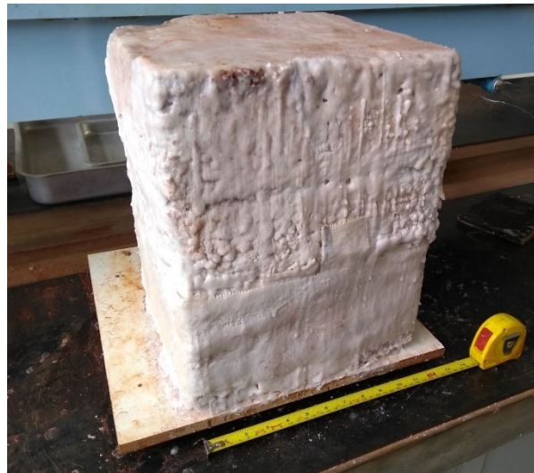
Figura 35. Amostra indeformada extraída do campo experimental.
