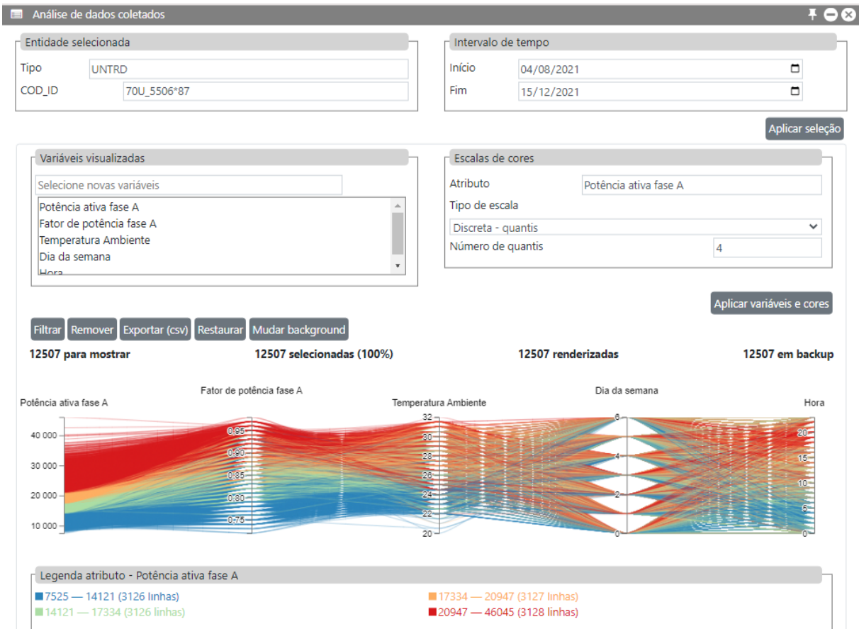
Figura 41 – Dados de um transformador em coordenadas paralelas.
