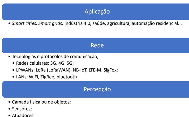
Figura 2 – Arquitetura de 3 camadas para sistemas de IoT.
