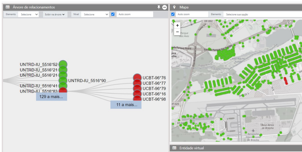
Figura 32 – Eventos em um transformador de distribuição e em 16 unidades consumidoras a jusante do transformador.
