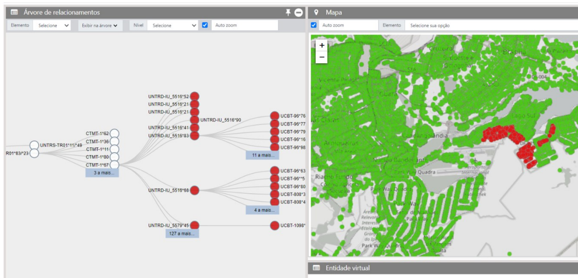
Figura 33 – Eventos em 112 transformadores de distribuição e cerca de 1500 unidades consumidoras, relacionados a um circuito de média tensão.
