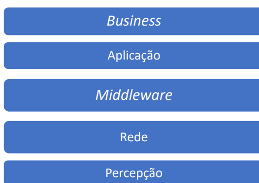
Figura 4 – Arquitetura de 5 camadas com middleware para sistemas de IoT.
