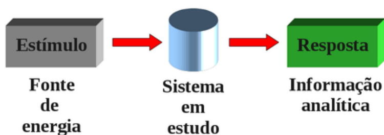
Figura 5 - Diagrama de blocos mostrando uma visão geral de uma medida instrumental.
