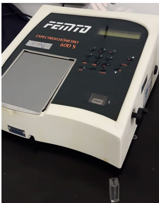
Figura 22 - Equipamento utilizado: Espectrofotômetro UV-Vis, (FEMTO, modelo: 600S)
