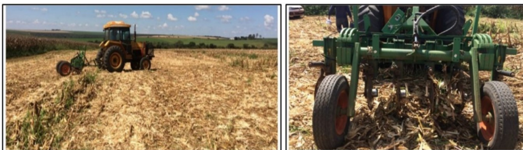
Figura 1. Leituras de condutividade elétrica aparente de solo aparente com uso do sensor Veris® em área experimental localizada na Fazenda Eldorado em Uberlândia, Minas Gerais.
