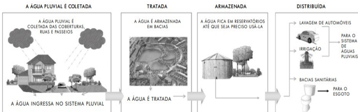
Figura 3: Sistema de coleta de águas pluviais na Nova Zelândia
