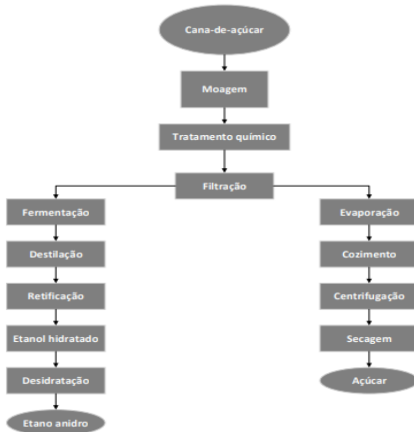
Figura 5 – Fluxograma produção açúcar e álcool
