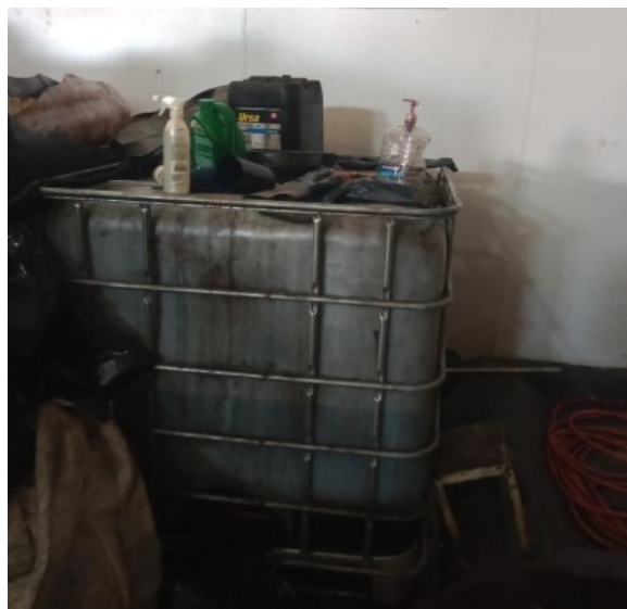
Foto 11: Reservatório IBC sujo e com material indevido
