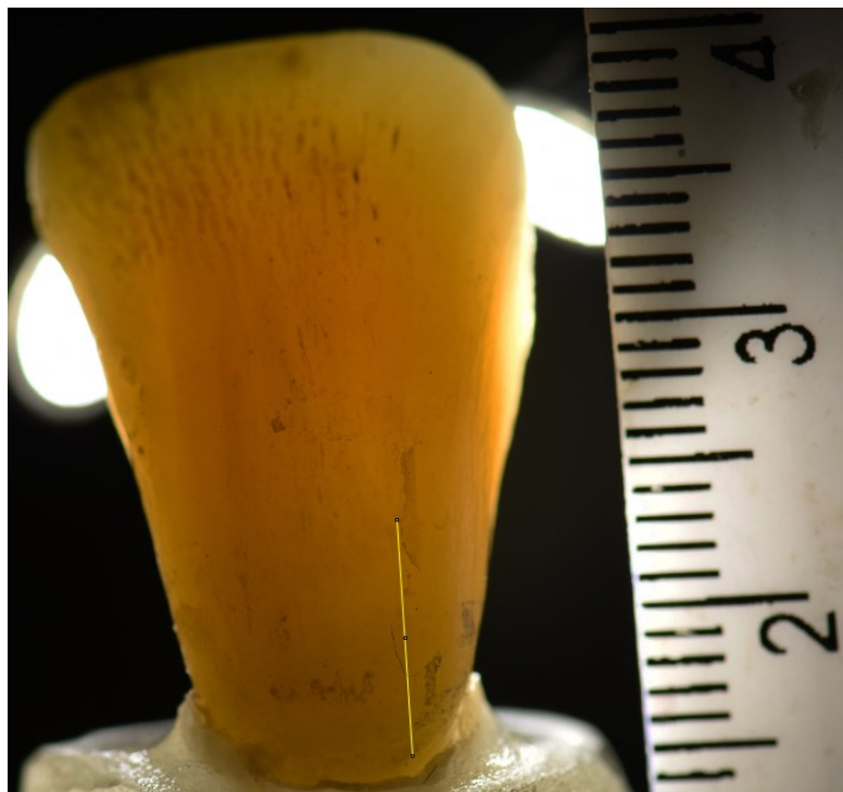
Figura 5: T 2 após cisalhamento (trinca 8.108 mm)
