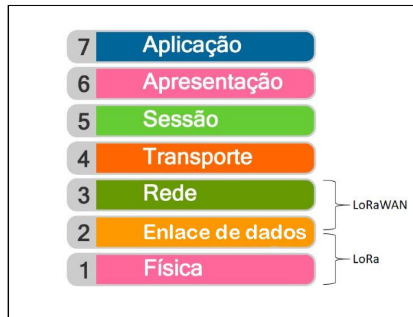
Figura 2.32 - Diferenças entre LoRa e LoRaWAN no modelo OSI
