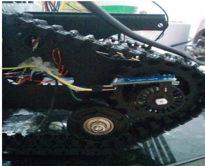
Figura 4.5 - Encoder fixado na roda de condução
