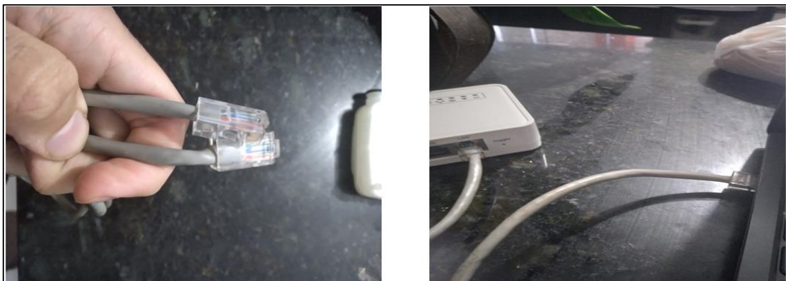
Figura 4.27 - Conexão do cabo rj45
