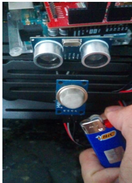
Figura 4.22 - Emitindo gás no sensor diretamente
