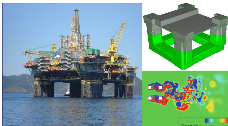
Figura 4 – Cilindros quadrados aplicados em plataforma semissubmersível
