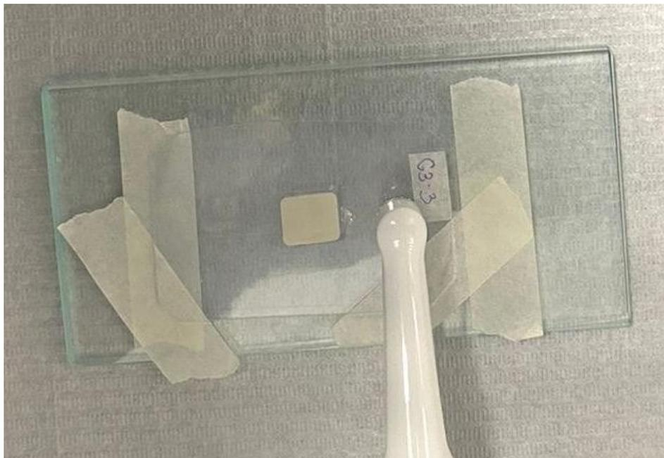
Figura 4: Cerâmica reforçada por Dissilicato de Lítio colocada sob o cimento resinoso, sendo separados por uma tira de poliéster.
