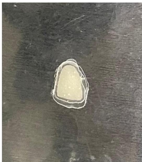
Figura 7: Gabarito de plástico com amostra de cimento fotopolimerizado na forma e dimensões médias de um incisivo central superior
