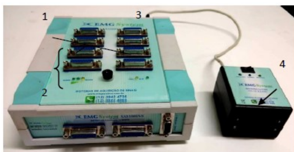
Figura 1. Eletromiógrafo. 1- Canais auxiliares para eletrogoniômetro e célula de carga; 2- canais para eletrodos de eletromiografia; 3- Entrada para eletrodo de referência; 4- Bateria
