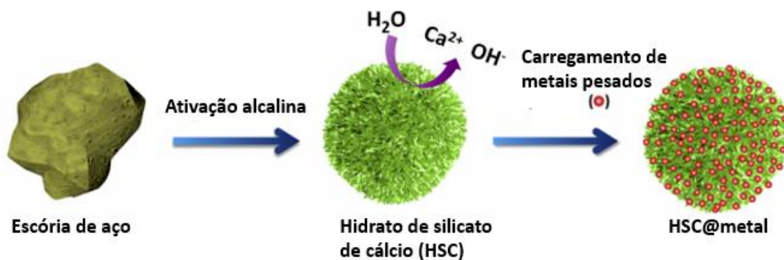
Figura 3.3. Processo esquemático da conversão de íons de metais pesados em fotocatalisadores por adsorção química pelo hidrato de silicato de cálcio derivado de escória de aço (Adaptada de Shao et al. , 2020).
