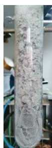
Figura 4.3. Reator contendo o bio-adsorvente de espumas de poliuretano produzido (Foto tirada pela autora).
