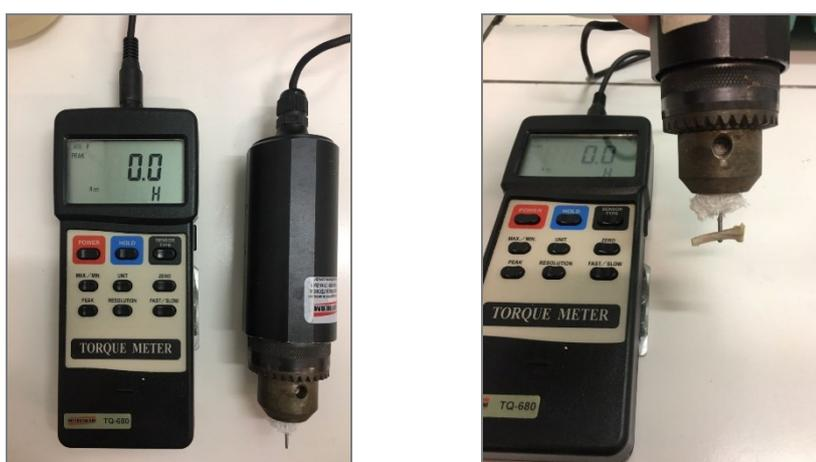
**Imagem 02. A-** Torquímetro; **B-** Torquímetro com tíbia em posição.
