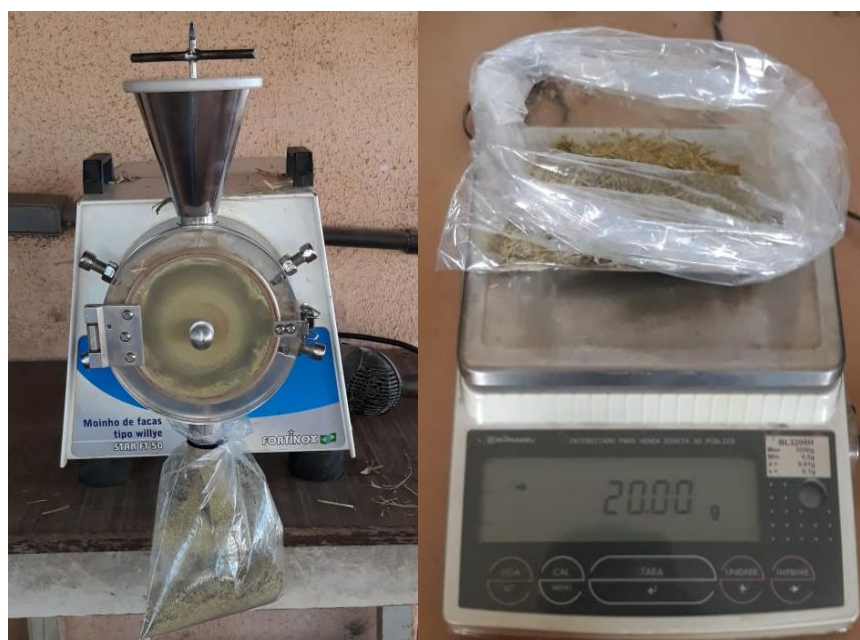
Figura 1. Moinho de facas tipo Wiley e balança semi-analítica utilizada para mensuração da resistência a moagem.
