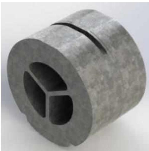
Figura 2.25 - Matriz em aço ferramenta H13 para extrusão de alumínio (KRAFT, 2015).
