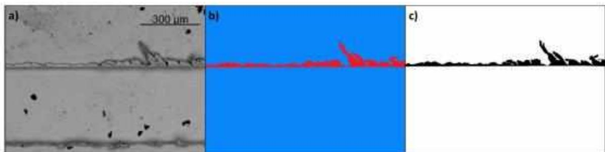
Figura 2.14 - Quantificação das rebarbas por medição de área: (a) imagem obtida no MEV; (b) isolamento da rebarba; (c) binarização e medição (Dos Santos, 2020)
