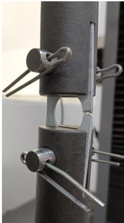
Figura 4.8 – Imagem de um CP fraturado logo após a execução do ensaio BTD-SEP. Condição ensaiada: 0,1M NaOH + 1g/L Tiocianato com velocidade de 1  $\mu\text{m/s}$ .
