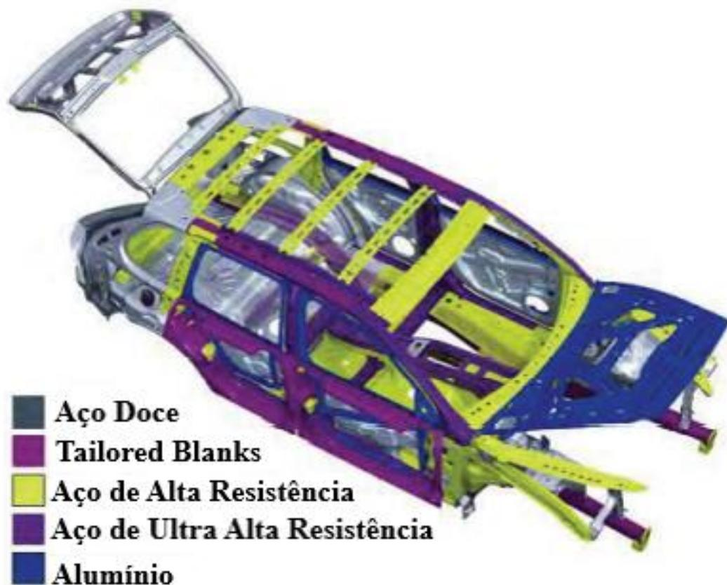
Figura 2.1 – Representação da aplicação dos aços e alumínio na construção da carroceria de um automóvel (Adaptado LAHAIJE, 2014).
