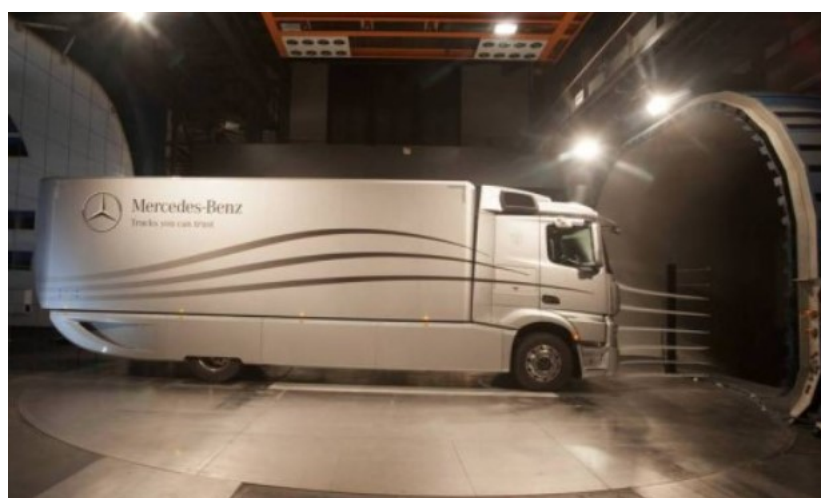
Figura 43 - Caminhão Mercedes-Benz no túnel de vento mostrando a carenagem lateral diminuindo o vão livre com o solo, o defletor no teto e o baú arredondado (Fonte: autoentusiastas.com.br, acessado em 18/04/2022)
