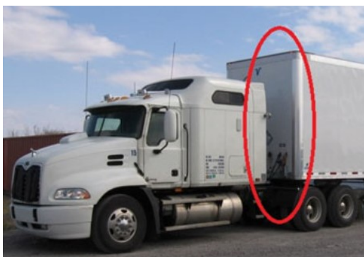
Figura 37 - Folga típica de conjunto cavalo mecânico e semirreboque (Fonte: Transport Canada, 2015)
