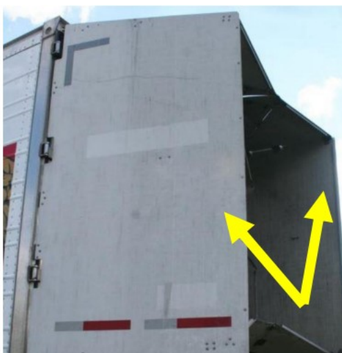
Figura 44 - Flaps utilizados na traseira do baú para reduzir o arrasto (Fonte: Trucking efficiency 2017)
