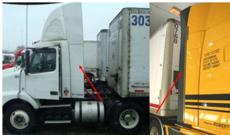
Figura 39 - Extensores laterais de cabine (Fonte: Transport Canada, 2015)
