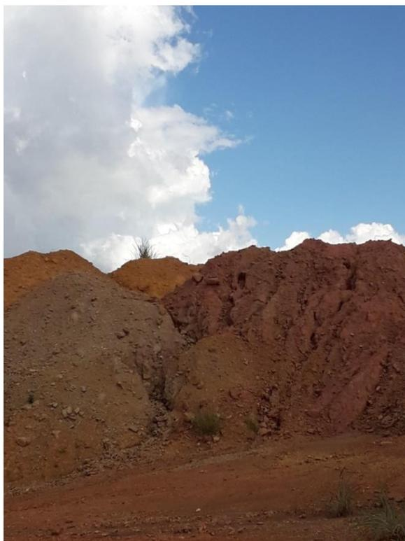
Observa-se que os estéreis estão dispostos incorretamente na área da mina, pois não apresentam controle geotécnico nem hidrológico que garantam a estabilidade deles. A área não se constitui em área de risco, pois não se encontram instalações próximas, mas sua dispersão sem controle pode ocasionar processos de assoreamento e impermeabilização dos solos.
