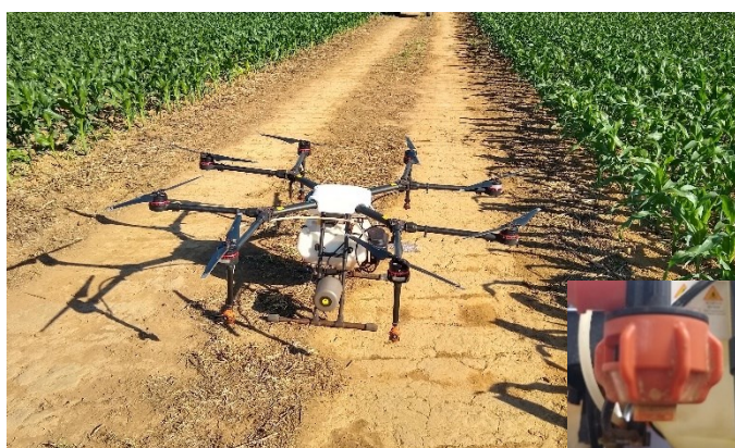
FIGURA 1. Aeronave remotamente pilotada empregada nos ensaios, com detalhe da ponta XR 11001.
