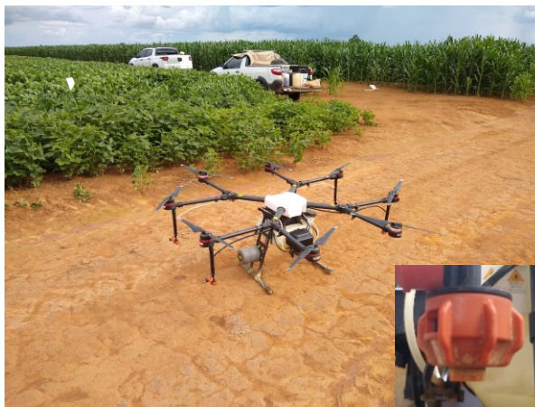
FIGURA 1. Aeronave remotamente pilotada empregada nos ensaios, com detalhe da ponta XR 11001.
