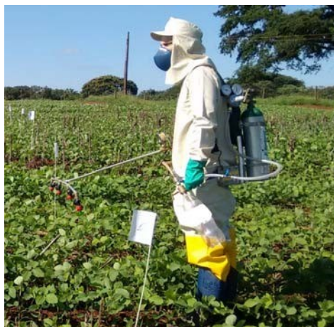
FIGURA 2. Pulverizador costal a pressão constante ( \text{CO}_2 ) usado na aplicação do solo'.
