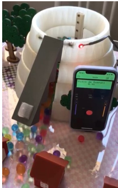
Figura 49 - Risco de rompimento alto com luz led vermelha.
