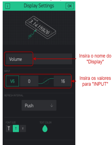
Figura 69 - Inserir o display do volume da barragem.
