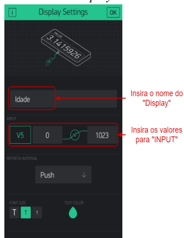
Figura 65 – Inserir o display da idade da barragem.
