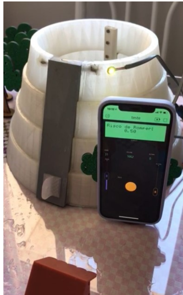
Figura 48 - Risco de rompimento médio com luz led amarela.
