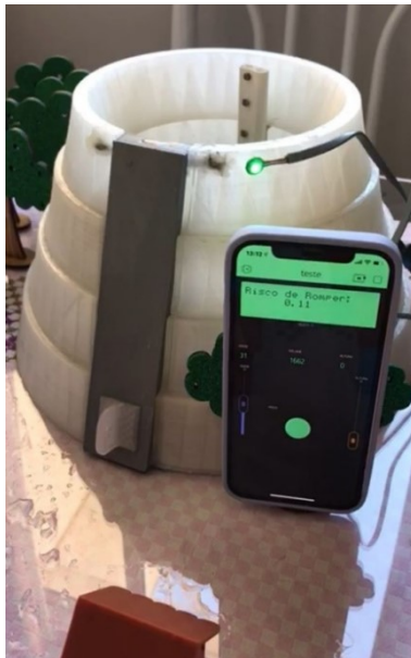
Figura 47 - Risco de rompimento baixo com luz led verde.
