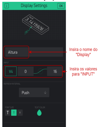
Figura 73 - Inserir o display do volume da barragem.
