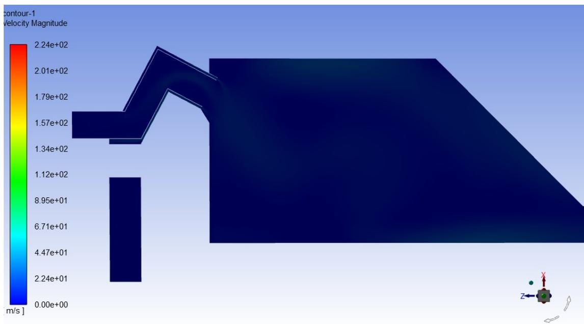
**Figura 23:** Velocidade do duto do gás de entrada inferior com escala até 224.69 m/s.
