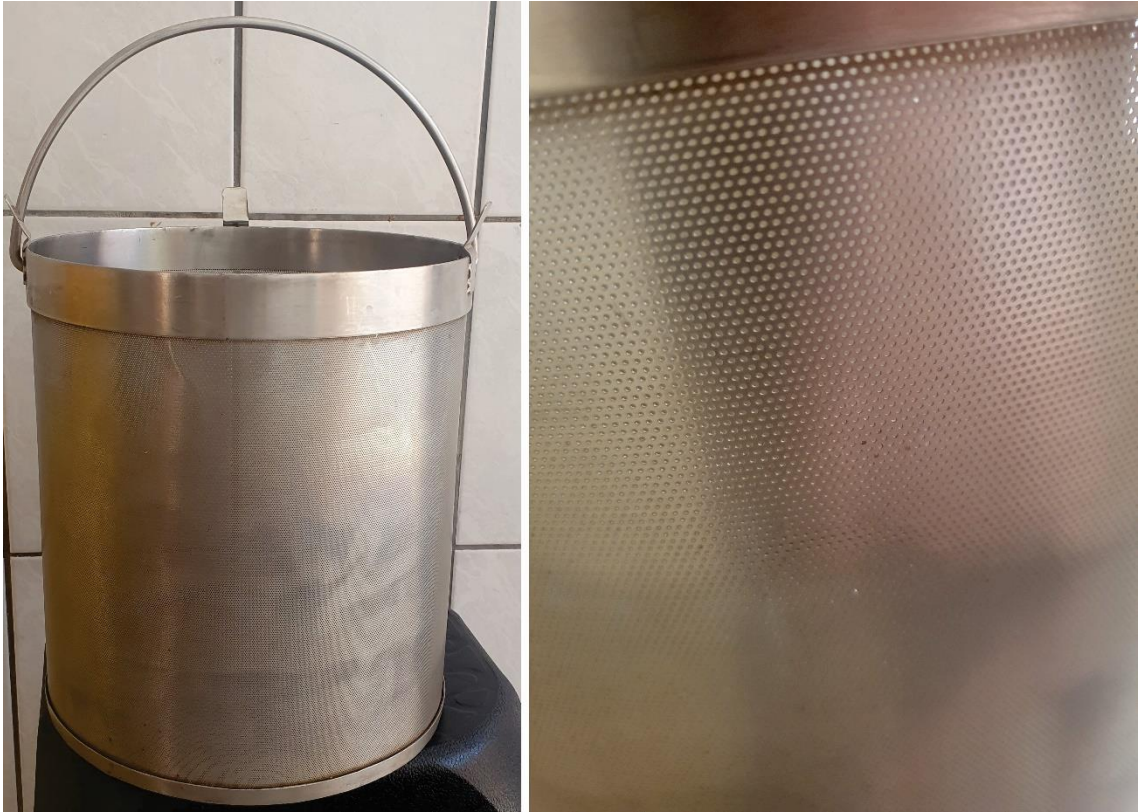
Figura 17 - (a): Cesto de grãos utilizado. (b): Malha do cesto
