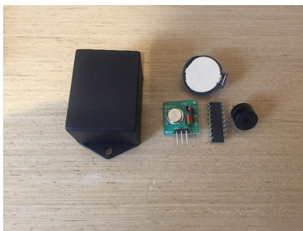
CAIXA EXTERNA, RECEPTOR DE RÁDIO FREQUÊNCIA, BUZZER, BATERIA 3V
