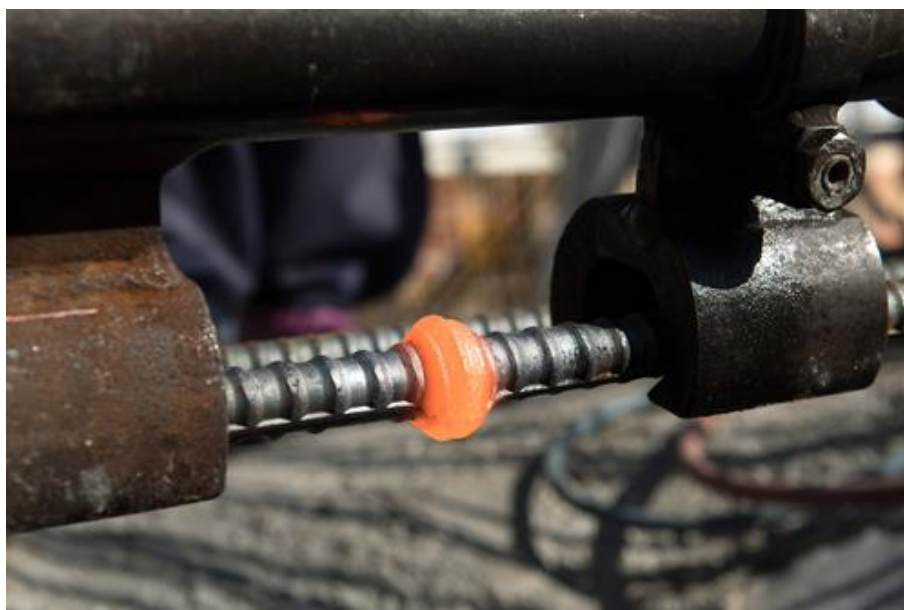
Figura 2 – Um exemplo da soldagem por Pressão, Aventa (2018).
