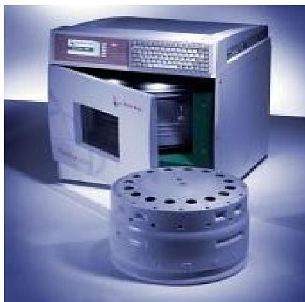
Figura 10: Foto ilustrativa de aparelho de micro-ondas Atom Paar GmbH Synthos 3000
