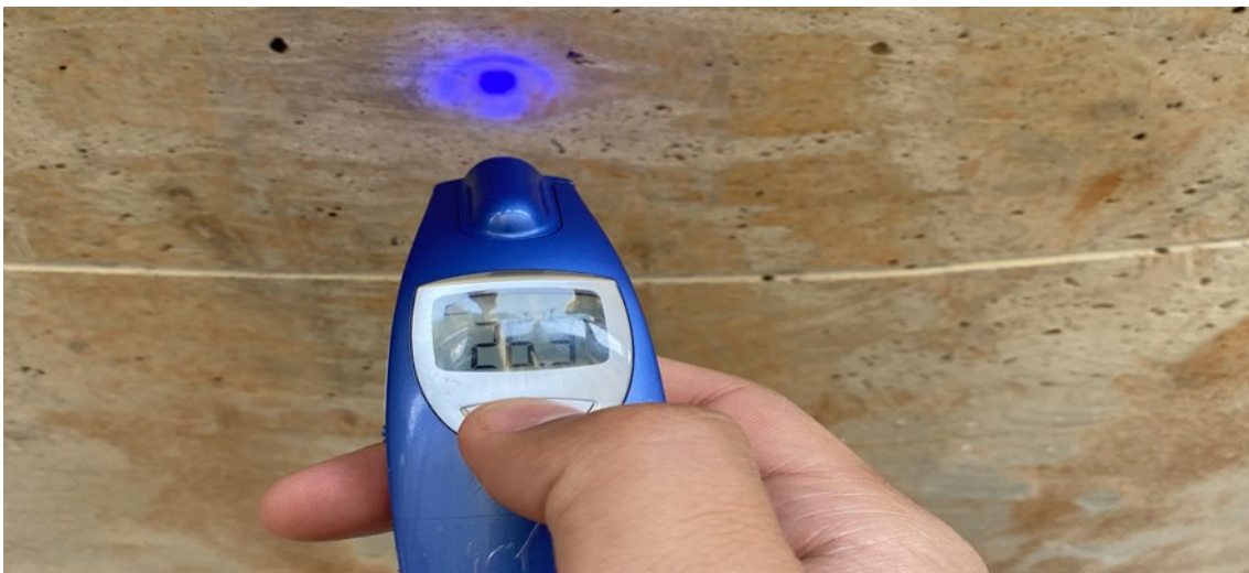
Figura 19 – Aferição da temperatura da base de aplicação
