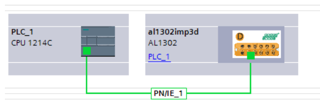
Figura 40 – Rede entre o PLC e o Mestre
