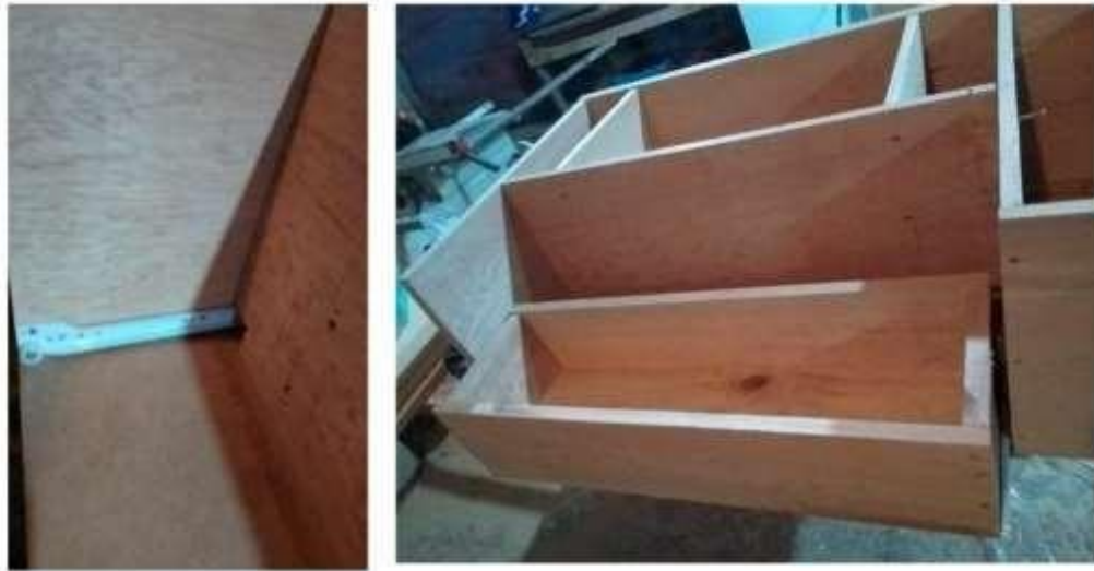
Figura 51 - Montagem da gaveta
