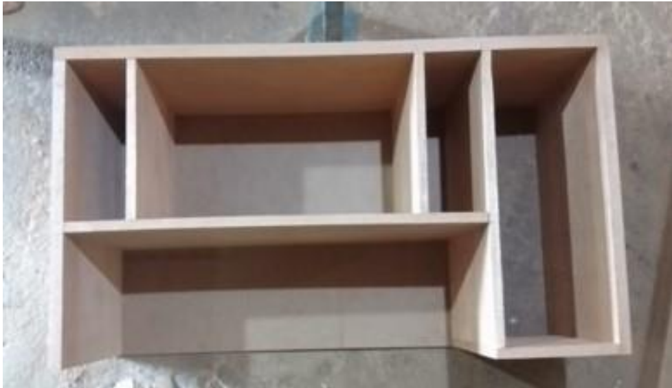
Figura 49 - Montagem dos nichos do baú
