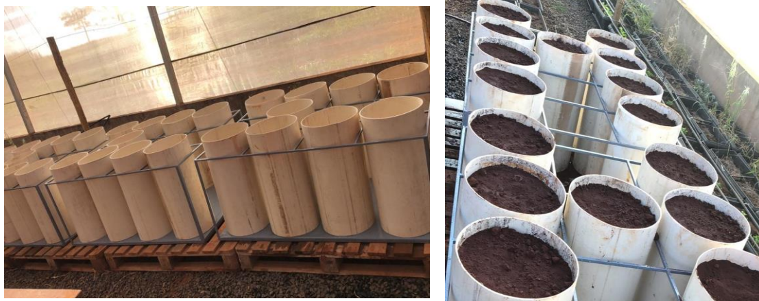
Figura 1. Parcela experimental composta por vaso de PVC com 30 cm de diâmetro e 60 cm de altura.
