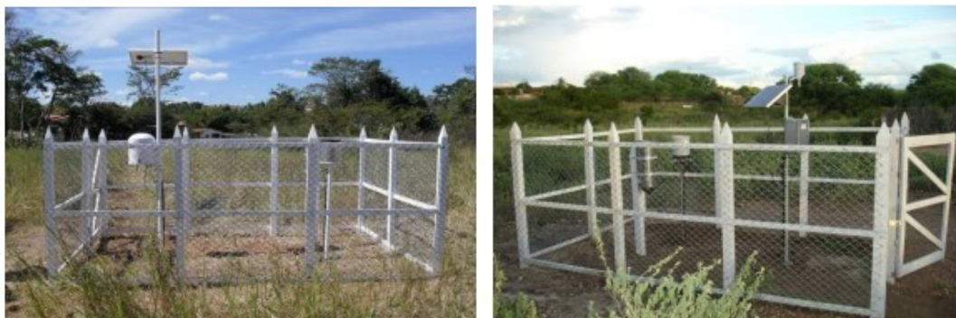
Figura 5 – Exemplo de estações pluviométricas automáticas instaladas pela ANA
