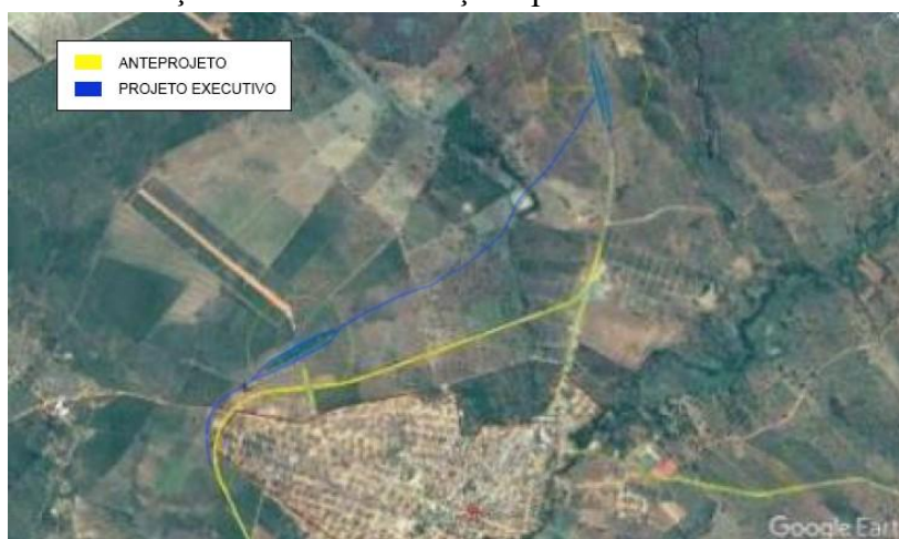
Figura 11 – Ilustração de desvio no traçado por interferência em zona urbana.
