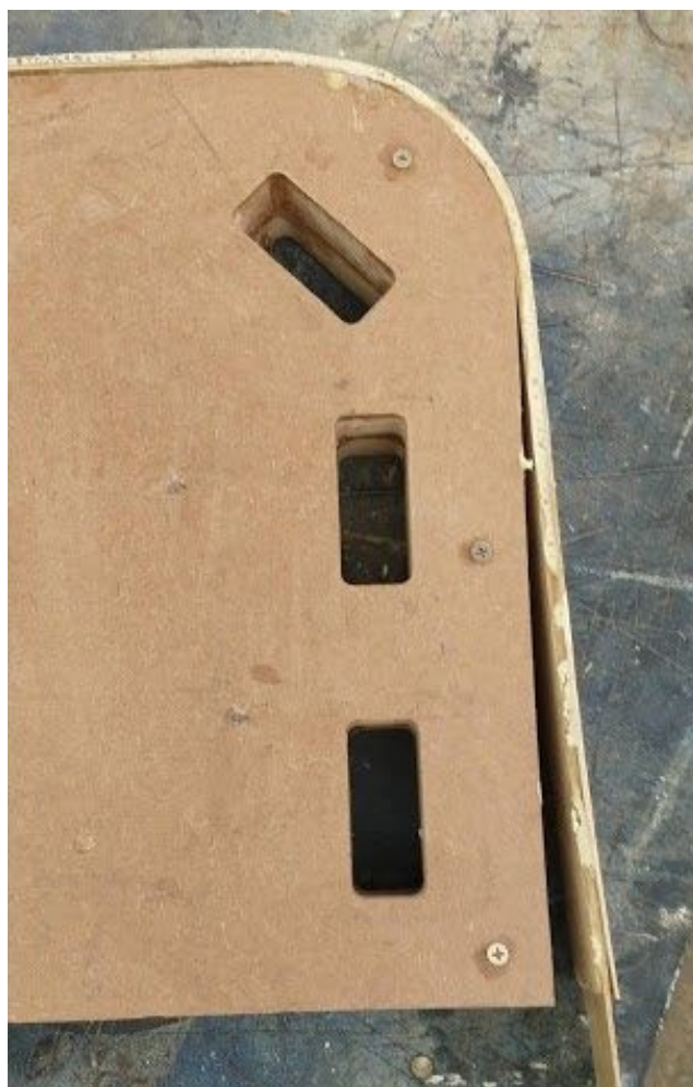
Figura 22. Springback obtido após 24hrs (Fonte: Elaboração do autor)
