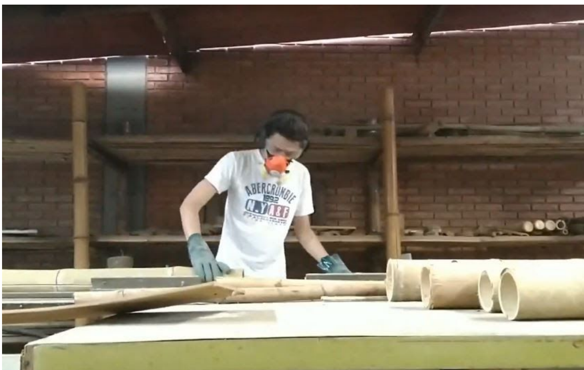
Figura 13. Corte longitudinal em serra circular dupla (Fonte: Elaboração do autor)
