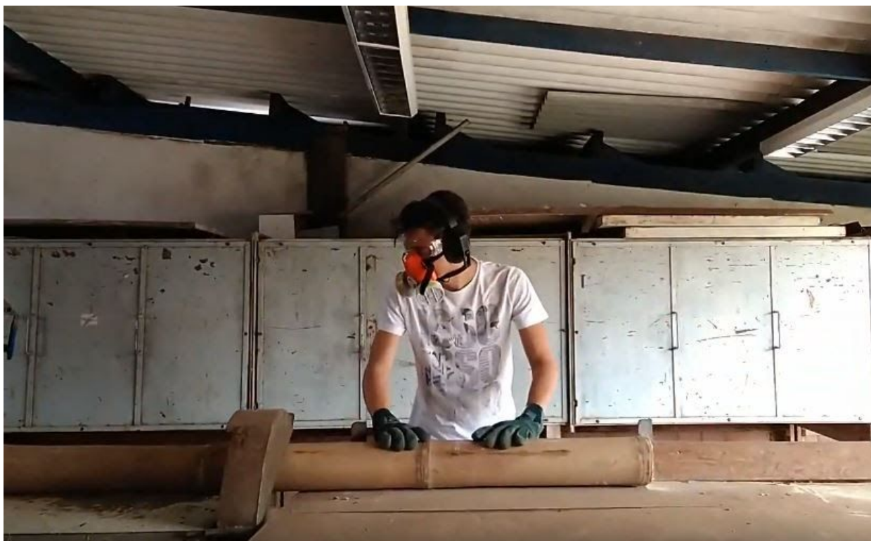
Figura 11. Corte transversal com serra circular (Fonte: Elaboração do autor)
