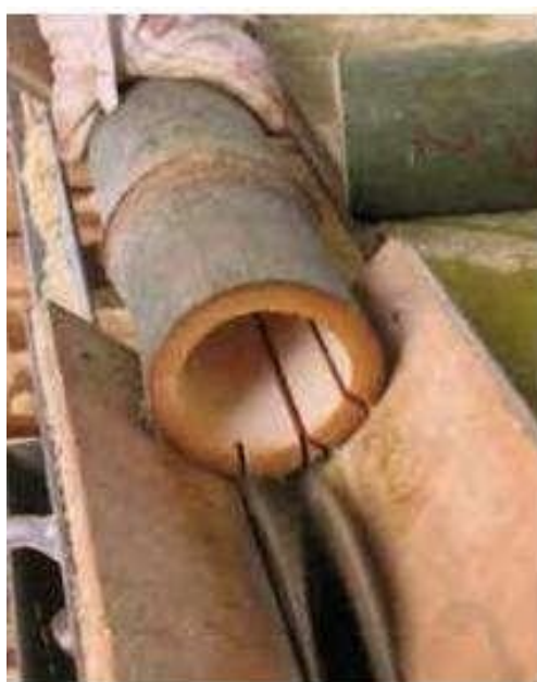
Figura 12. Corte longitudinal em serra circular dupla (Fonte: PEREIRA, 2012)
