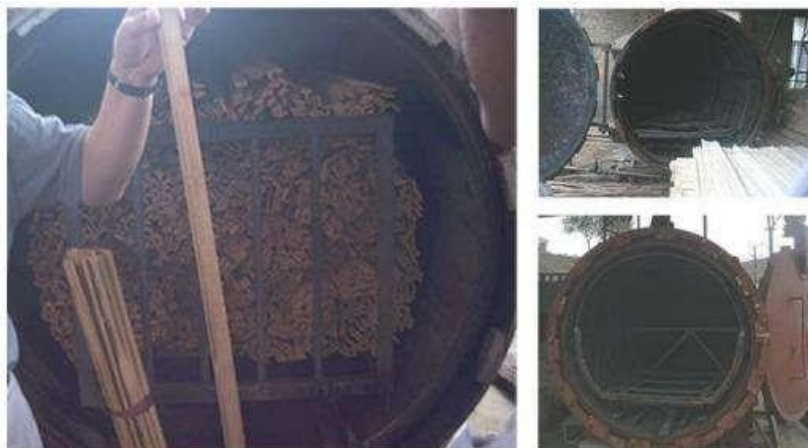
Figura 25. Forno ou caldeira para a carbonização das ripas, China.
