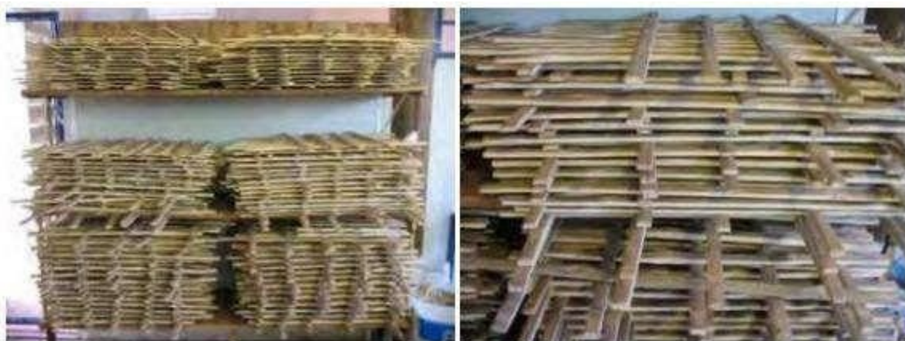
Figura 16. Armazenamento e secagem das ripas (Fonte: PEREIRA, 2012)
