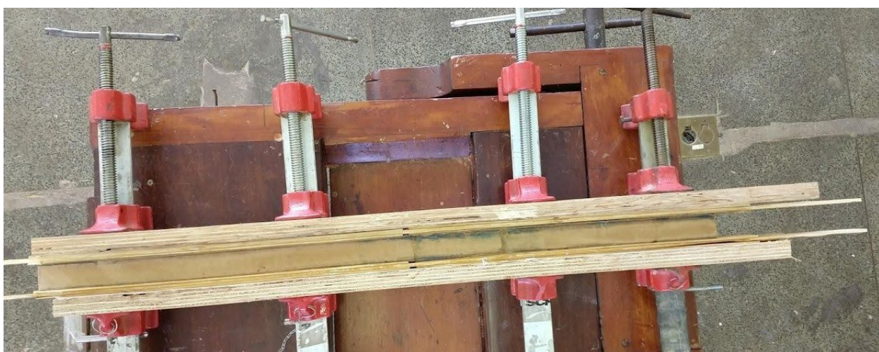
Figura 20. Prensa para colagem em espessura. (Fonte: Elaboração do autor)
