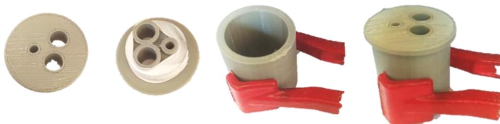
**Figura 1.** Célula eletroquímica, fabricada em impressora 3D usando filamento ABS.
