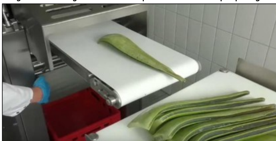
Figura 26 - Filetagem da Aloe vera que elimina uma face por passagem
