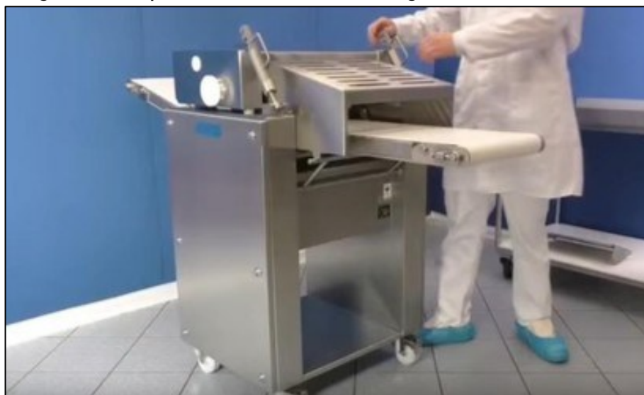
Figura 25 - Máquina mecânica alemã de filetagem de folhas de Aloe vera
