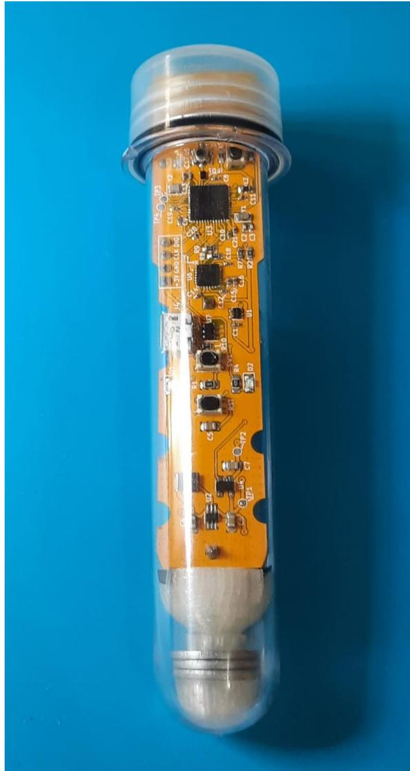
Para demonstração real de funcionamento do dispositivo, foi colocado o mesmo dentro de um recipiente com água Figura 94, e feito a coletas de dados de temperatura, inclinação, SG e RSSI, e apresentado esses dados coletados a partir de uma interface com o aplicativo Android ST BLE Sensor.
