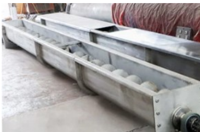
Figura 4 – Parafuso sem-fim e carcaça de alojamento em aço inoxidável.
