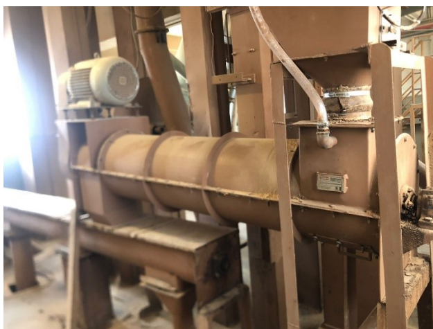
Figura 3 – Parafusos sem-fim de transporte em aço inoxidável. Fonte: autoria própria.
