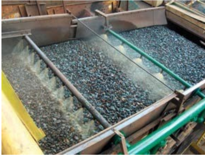
Figura 10 – Sistema de lavagem de minério de ferro. Fonte: (MINERALES, 2020)
