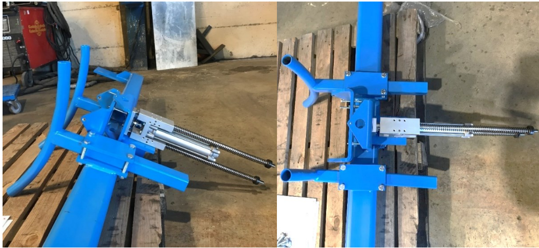
Figura 44 - Atuador pneumático com retorno por mola.
