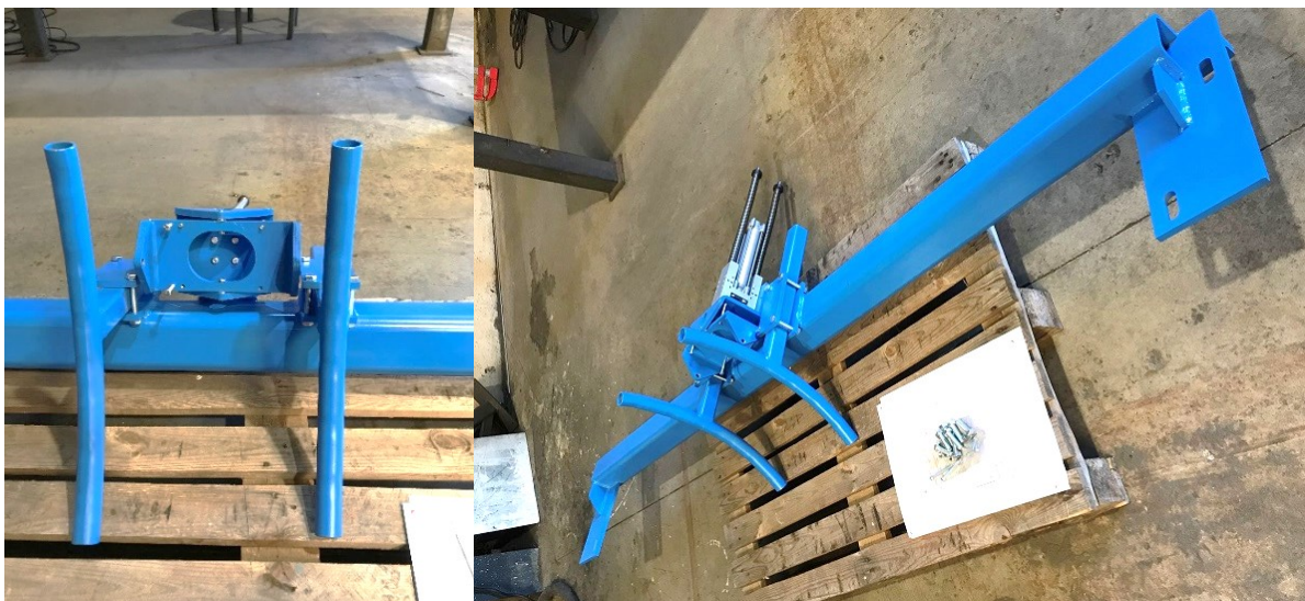
Figura 43 - Viga de sustentação do atuador pneumático.
