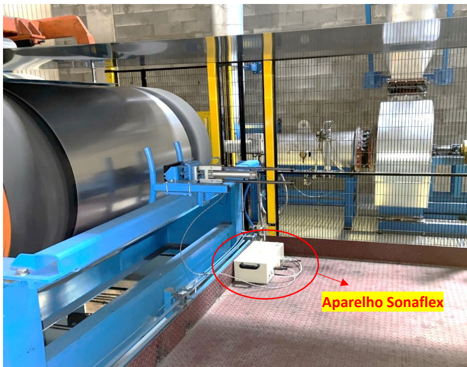
Figura 46 - Montagem do sistema no conjunto de rolos BS6.
