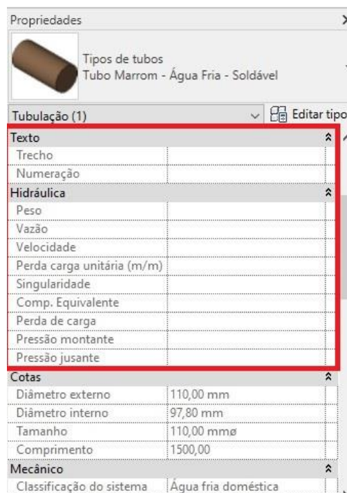
Figura 20 - Parâmetros compartilhados de uma tubulação qualquer.
