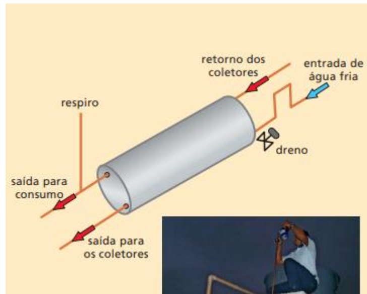
Figura 62 - Ilustração esquemática do respiro na saída do reservatório de água quente.
