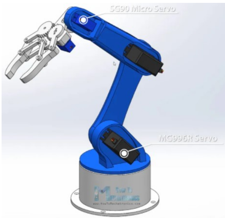
Imagem 24 – Estrutura física do robô impresso em 3D
