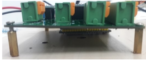
Imagem 36 – Detalhe da fixação do módulo ESP32
